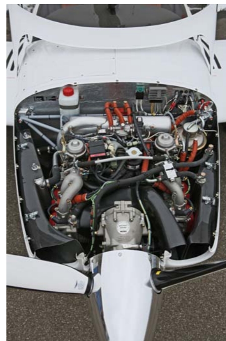
Saubere Verarbeitung und aufgeräumter Motorenraum; verstellbarer Dreiblattpropeller von Woodcomp.
