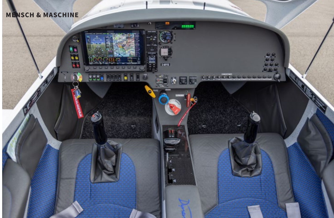
Aufgeräumt Dynon-Avionik und farbig klar markierte Schalter sorgen für Überblick im Panel
