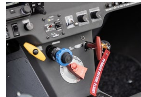
Elektrisch Die Landeklappen ebenso wie zwei Kühlluftklappen für Öl- und Wasserkühler werden mit Elektromotoren verstellt
