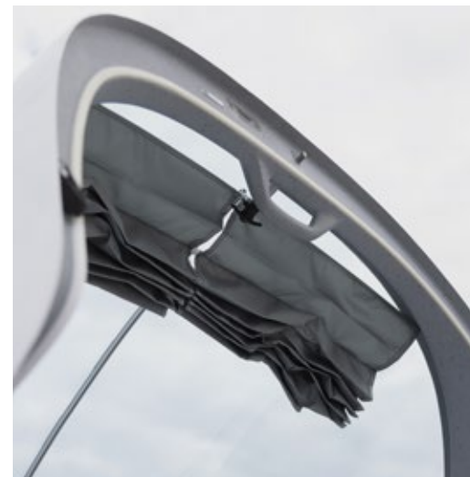
Dach über dem Kopf Die große Haube bietet eine gute Rundumsicht, doch bei starker Sonneneinstrahlung bietet eine optionale Jalousie Schatten
