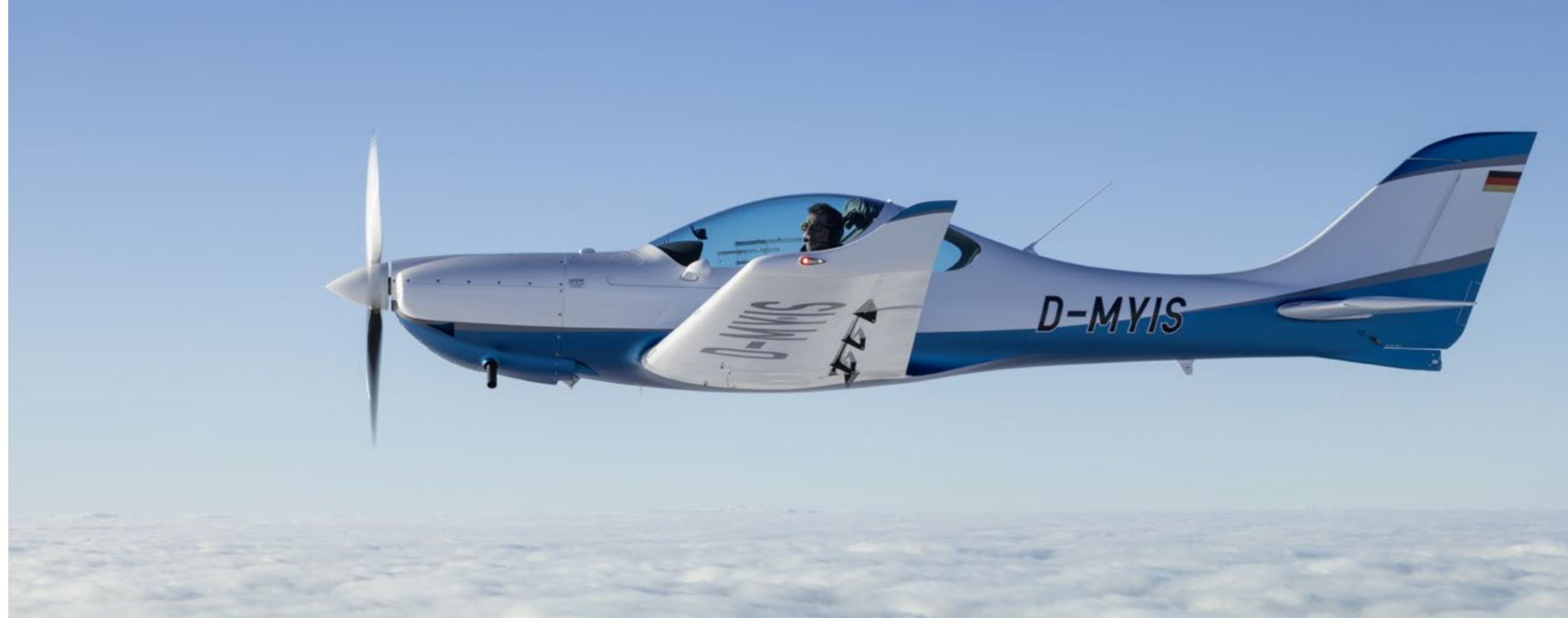
Gestreckte Cowling Damit der Rotax 915 iS passt, wurde die Verkleidung verlängert – und zugleich der Übergang zur Cockpithaube aerodynamisch optimiert
