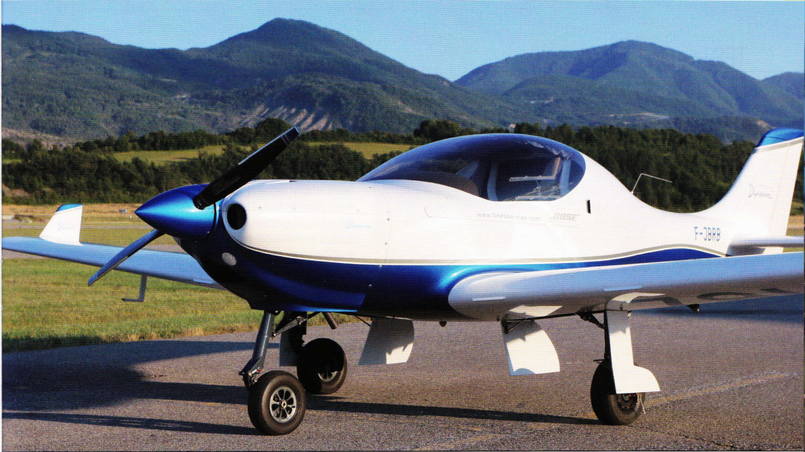
Gut erkennbar sind die beiden offenen Klappen der Fahrwerkschächte, die bei eingefahrenem Fahrwerk die Tragflächenunterseite nahtlos schließen.
