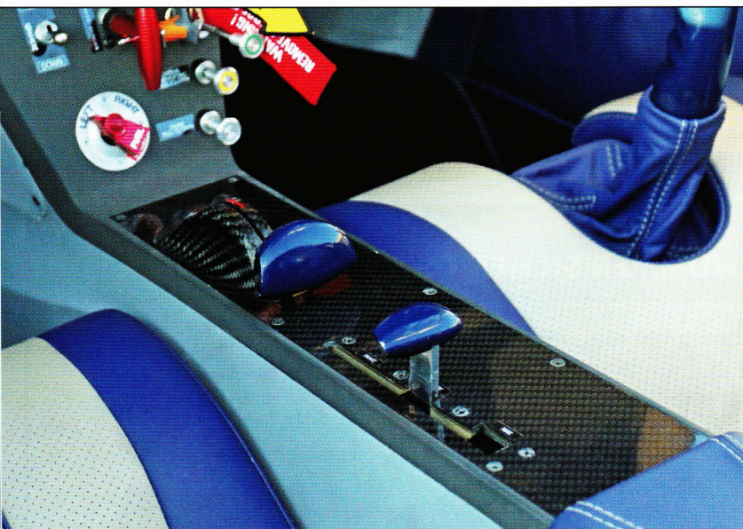
Auf der horizontalen Mittelkonsole finden wir die Hebel fürs Gas, die Bremsen und die Klappen. Man beachte auch das schöne Finish und die Qualität der Lederpolsterung.
