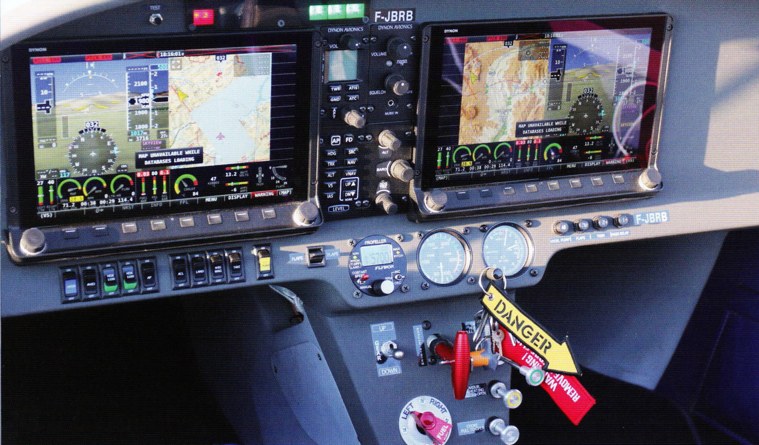
Unsere Testmaschine ist exklusiv mit zwei Glascockpits von Dynon und einem Autopiloten ausgestattet. Funk und Autopilot-Bedienung liegen zwischen den beiden Bildschirmen.
