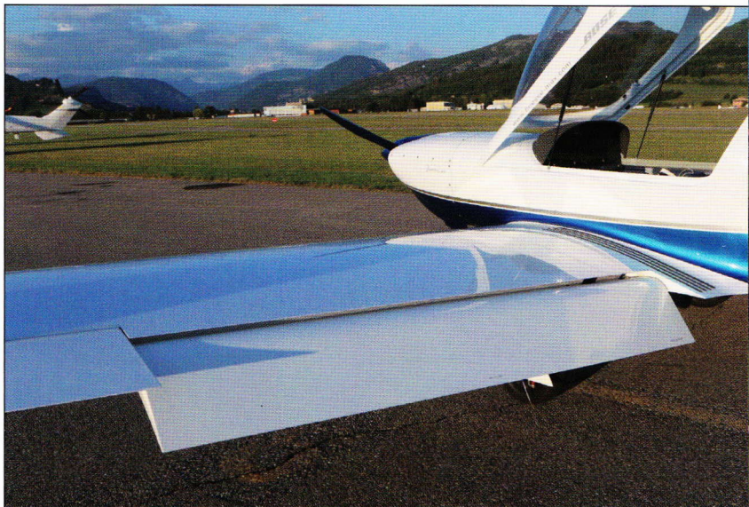
Die Dynamic WT9 ist mit sehr wirkungsvollen Dreistufen-Klappen ausgerüstet. Die sind auch nötig, um den schnellen Vogel für den Landeanflug abzubremesen.
